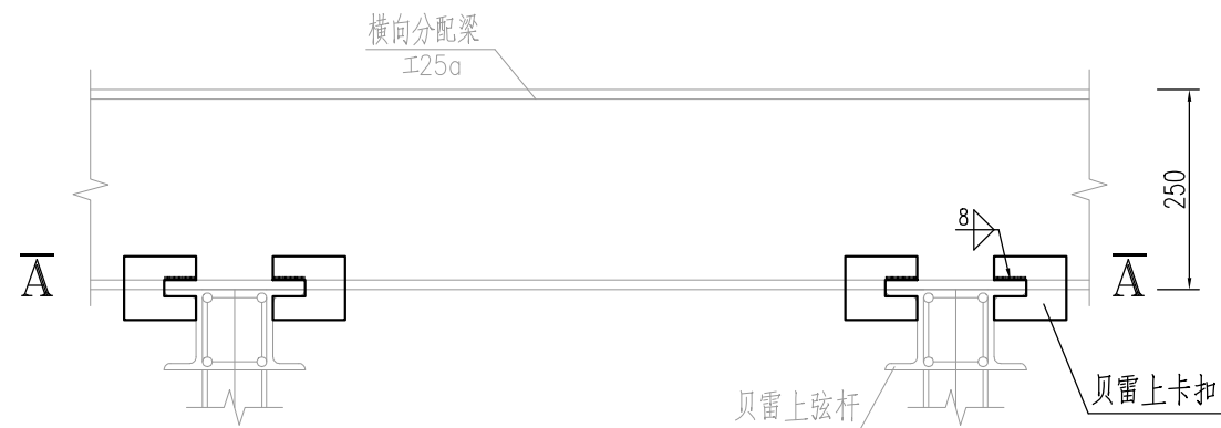
横向分配梁与贝雷片连接大样图 1:10
